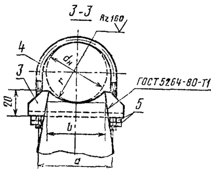
1—корпус; 2—ребро; 3—проушина; 4—хомут; 5—гайка по ГОСТ 5915—70.
