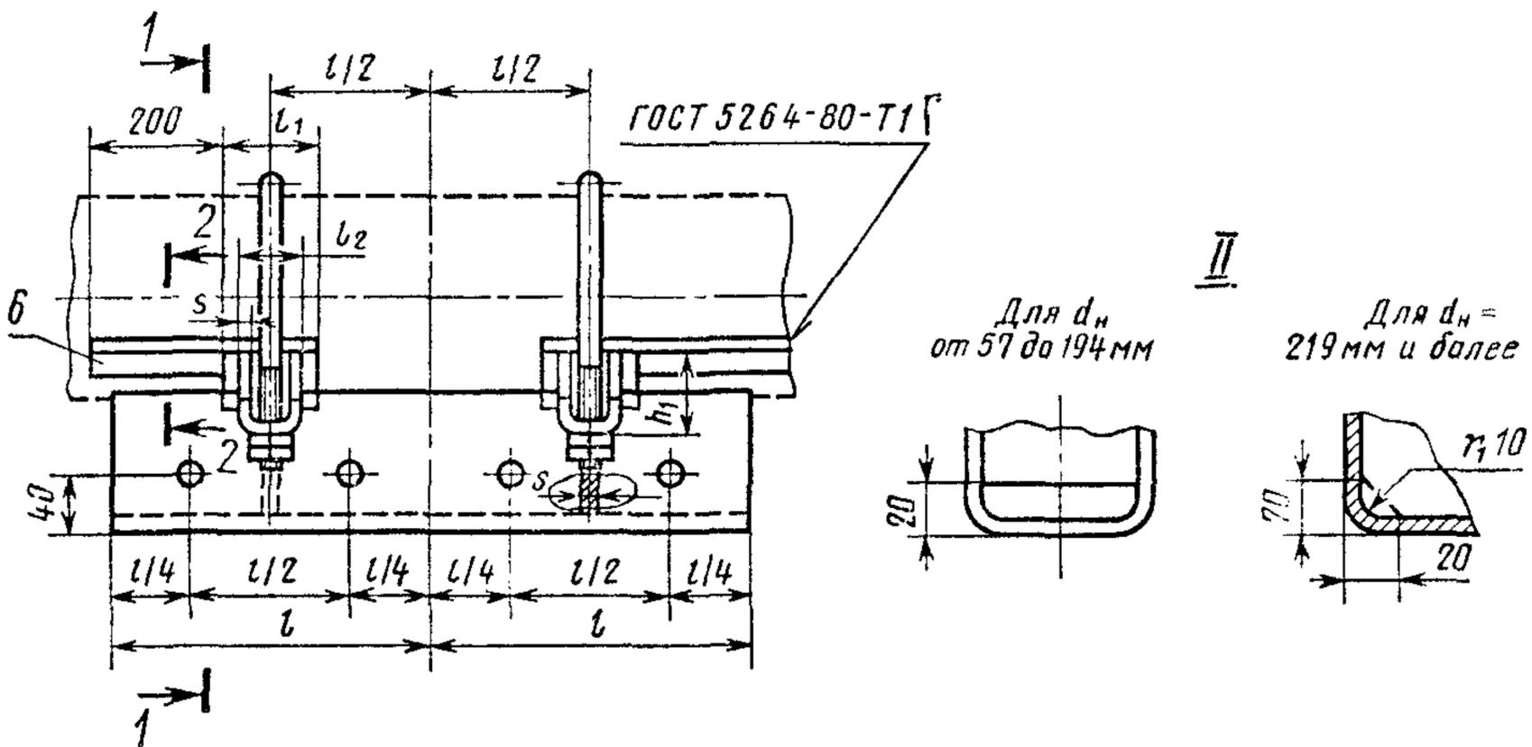
1—корпус; 2—ребро; 3—проушина; 4—хомут; 5—гайка по ГОСТ 5915—70; 6—упор для  $d_n=377$  мм и более; 7—подушка.
